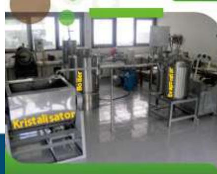
Teknologi integrasi pengolahan gula semut yang terdiri dari unit boiler, evaporator, dan kristalisator. Bahan konstruksi menggunakan stainless steel yang bersifat food grade.
